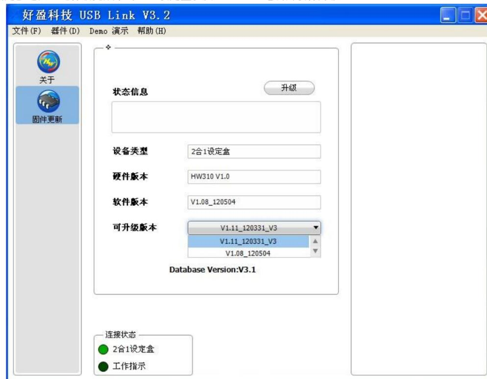
图 2 USB LINK 软件中的产品升级界面
